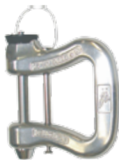
■Charly ピンロック 航空機用クイックピン 採用。アルミ合金のキャ ストメタルなので、マイク ロクラックによる破損の可 能性が極めて小さく安 心。内径40mm、80g 破 断強度 25KN ¥7,000+税
